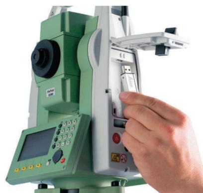
Leica FlexLine TS06plus имеет коммуникационную панель, позволяющую подключиться к любому устройству обработки и хранения данных по Bluetooth: например, к контроллерам Leica Viva CS10 или Leica Viva CS15 с установленным ПО SmartWorks Viva. USB накопитель позволяет передавать данные в форматах GSI, DXF, ASCII, LandXML и CSV.
