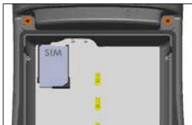
Чтобы удалить SIM карту, выдвиньте лоток из гнезда и вытащите карту. Задвиньте лоток на место в гнездо до упора.
