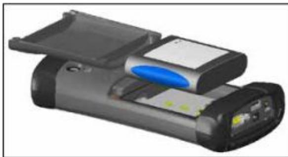
2. Если Вы для расширения памяти контроллера Вы используете карты памяти SD или SIM карту для использования 3G модема (Опция), Вы можете установить их в слоты перед установкой аккумулятора или в любое другое время. Подробнее об этом см. в Главе 2 *Аппаратные компоненты* и в Главе 8 *3G модем. Установка SIM карты*.
